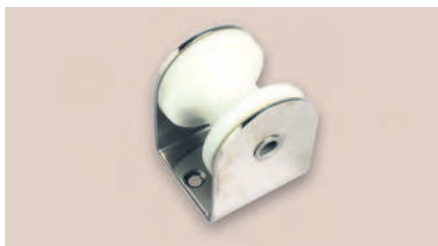
Cod. 357.00 Musone di prua in acciaio inox 316 lucidato a specchio. 60 x 60 sp. 3 mm Per ancore fino a 10 Kg
