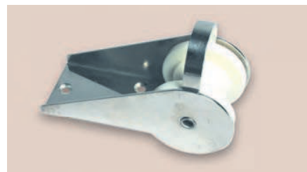
Cod. 357.02 Musone di prua in acciaio inox 316 lucidato a specchio. base appoggio 80 x 110 sp. 3 mm Per ancore fino a 10 Kg
