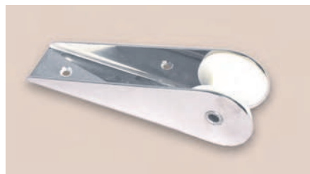
Cod. 357.01 Musone di prua in acciaio inox 316 lucidato a specchio. base appoggio 150x 50 sp. 3 mm Per ancore fino a 10 Kg
