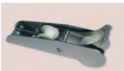
Cod. 357.03 Musone basculante in acciaio inox 316 lucidato a specchio. Appoggio 68 x 180 lungh. totale 330 sp. 3 mm Per ancore Bruce/Danforth fino a 10 Kg
