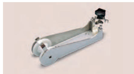
Musone in acciaio inox AISI 316 lucidati a spec- chio lungh. 330 largh. 80 sp. 4 mm con 1 bloc- caggio. Per ancore Bruce/ Danforth fino a 10 Kg Cod. 229.06
